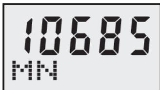
**Minulý náměr;** je pětímístná číselná hodnota. Označuje náměr indikátoru za proběhlé měřené období. V prvním roce indikace je zobrazena hodnota „0“.
