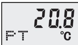
**Průměrná teplota \***; zobrazuje průměrnou teplotu místnosti od začátku měřeného období.
